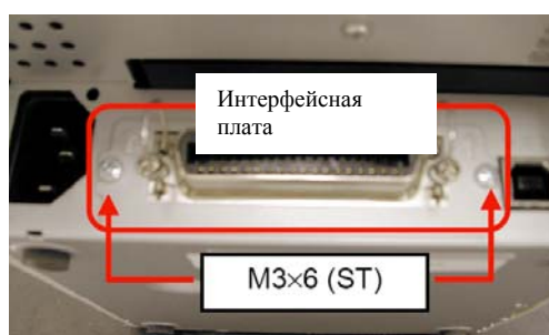
Рисунок 8 – Болты, крепящие интерфейсную плату принтера
