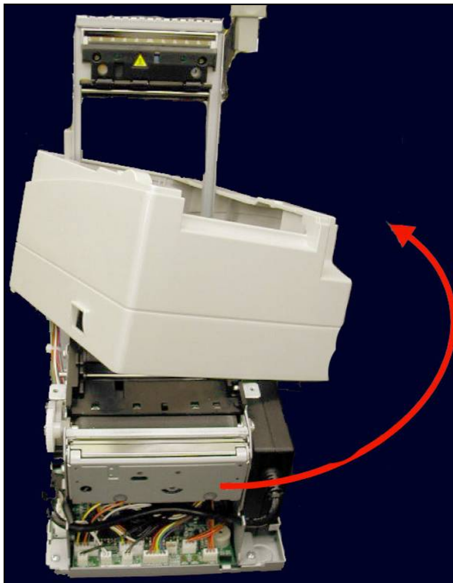
Рисунок 7 – Снятие кожуха принтера.
