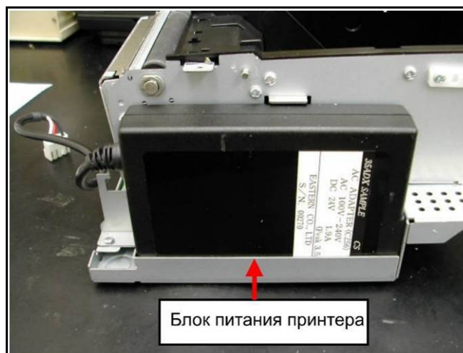
Рисунок 10 – Блок питания, установленный в принтере.
