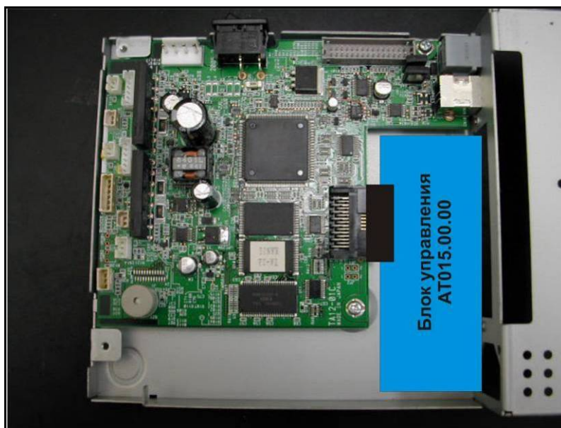
Рисунок 13 – Установка БУ в принтер.
