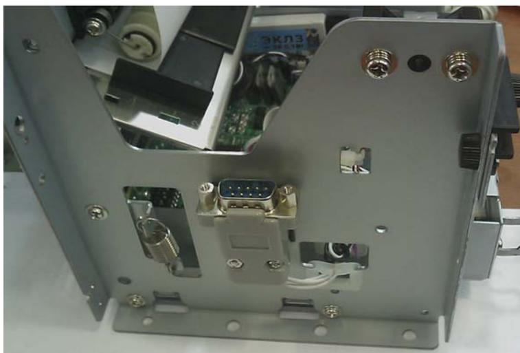
(При необходимости разобрать и собрать корпус разъема COM порта. Для удобства сборки, разъем может поставляться в разобранном виде)
